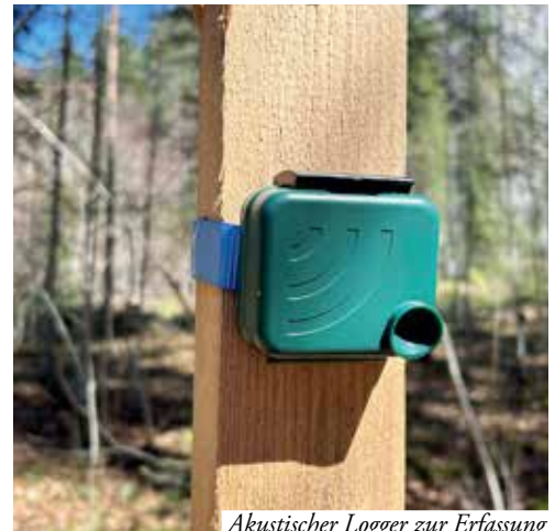
Akustischer Logger zur Erfassung von Vogel- und Fledermausrufen. Bild: Laura Vinter
