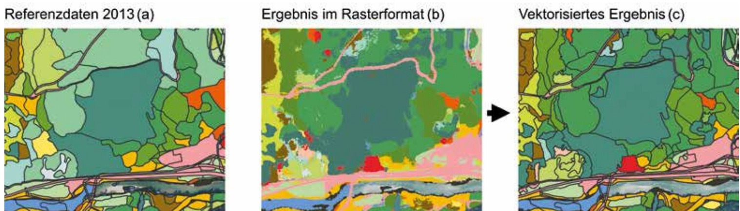
Abb.2: Veranschaulichung des Vektorisierungsschrittes: (a) visuelle Klassenzuordnung 2013; (b) Ergebnis der physikalisch-logischer KI 2020; (c) Ergebnis des Vektorisierungsschrittes 2020. Bild: Daniel Kulmer
