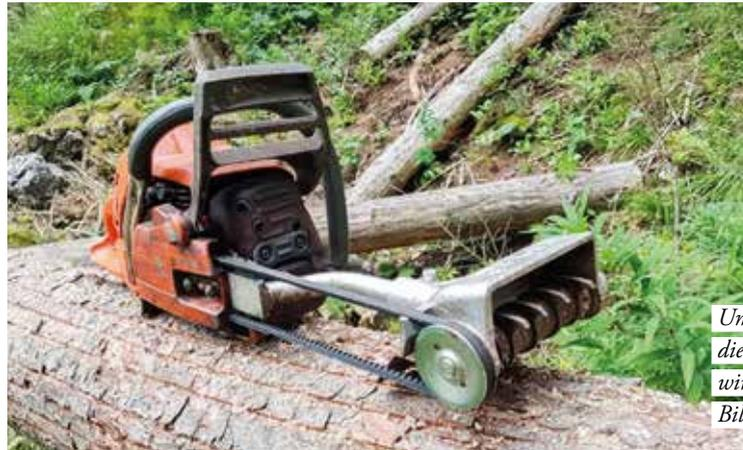
*Umgebaute Motorsäge, mit der die Rinde von Fichten „geschält“ wird, um rasch auszutrocknen.
