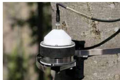
Automatisierte Dendrometer zur präzisen Messung des Baumumfangs
