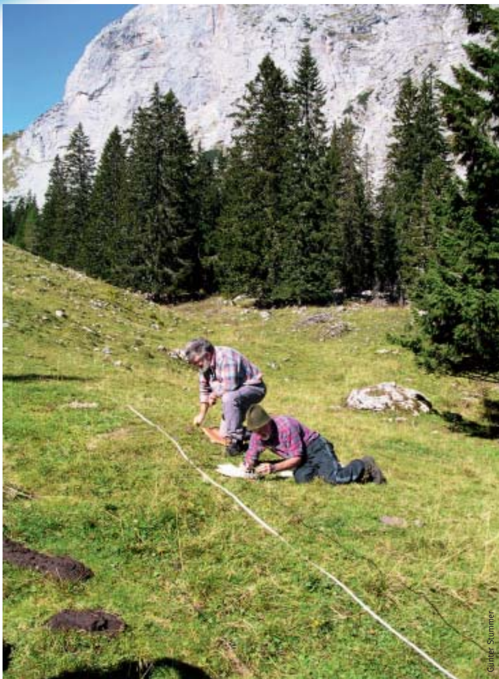
Mittels geophysikalischer Messungen kann auf die Untergrundverhältnisse (Zusammensetzung und Tiefe der Schichten) beim Sulzkarsee rückgeschlossen werden. Hier Mitarbeiter der karst- und höhlenkundlichen Abteilung des Naturhistorischen Museums in Wien beim „Abtasten“ des Untergrundes.
